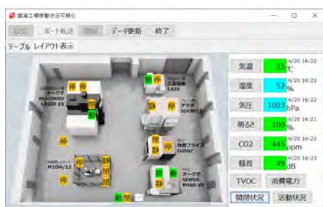
図 3: 自作センシング機器による状況可視化画面例
