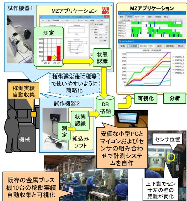
図 3:プレス機稼働実績の可視化
