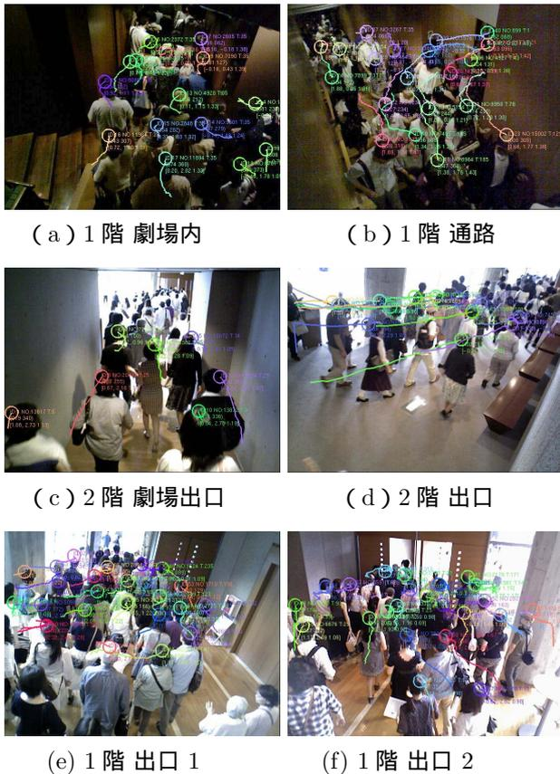
図 4: RGB-D カメラによる人の流れの計測結果
